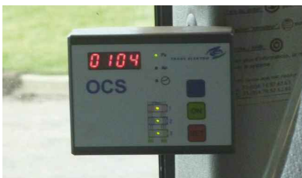
Boîtier d'affichage de la pression en cabine (Transelektro et BM Air)
