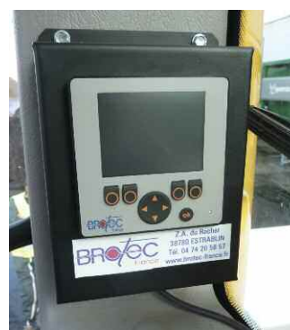
Boîtier d'affichage de la pression en cabine (Brotec)
