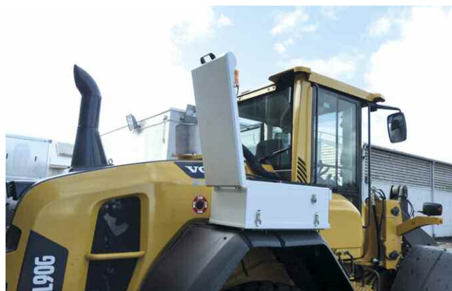
Caisson Brotec "dernière génération" avec cartouche de préfiltration à décolmatage automatique
